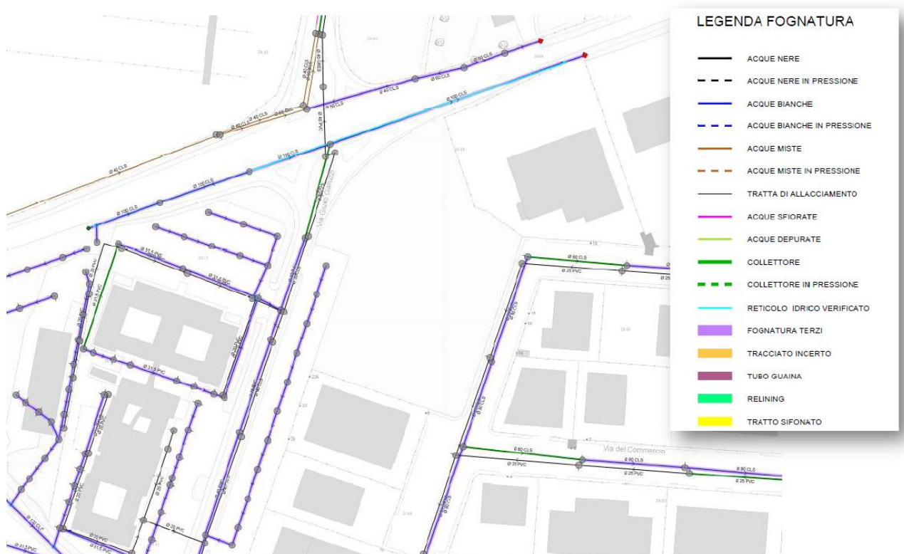
Figura 4-8 Rete Fognaria (fonte: Geoportale Padania Acque SpA)
